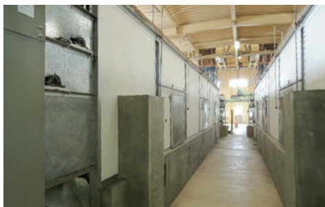
てん茶は、大正時代から続く伝統のレンガ積みてん茶炉で乾燥作業を行う。
